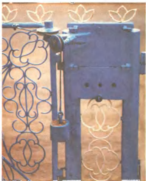
Фото 2. Механизм, закрывающий калитку, совсем прост (вид со двора), рядом — задняя стенка почтового ящика.
